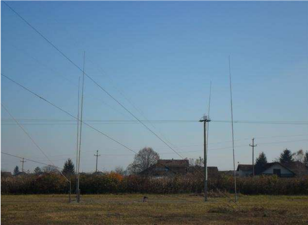
40m 4SQ sa 120 radijala po 12m dužine i nekih 100m 2 "chicken wire"
